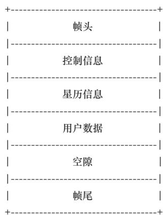
图2 加载星历信息的定长帧结构
